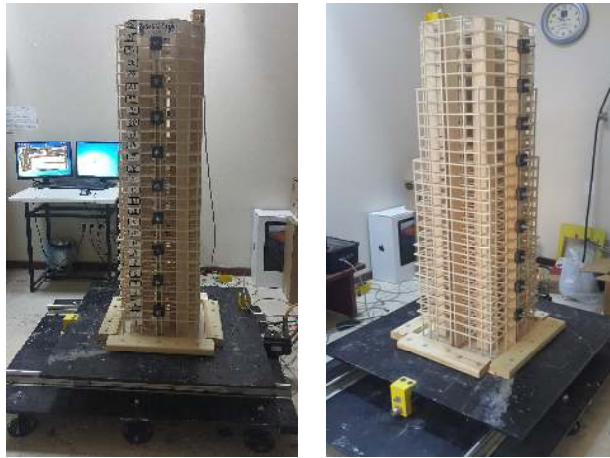
Şekil 2. Model yapı deney düzeneği
